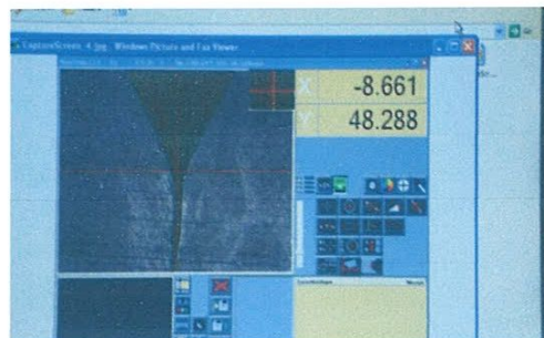
Figure 3-7 : Mesure et lecture des longueurs des ligaments sur un microscope optique.
