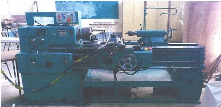
*Figure (II.1): Tour parallèle modèle SN 40C*
