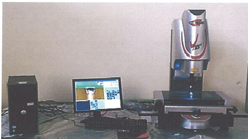
*Figure (II.5):VISUAL 250 pour la mesure de l'usure*
