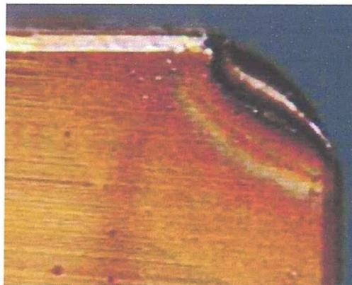
*Figure (I.16) : Phase d'usure par adhésion [1]*
