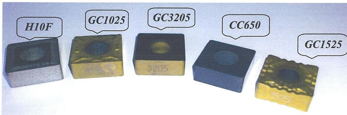
Figure (II.3): Plaquettes de coupe utilisées
