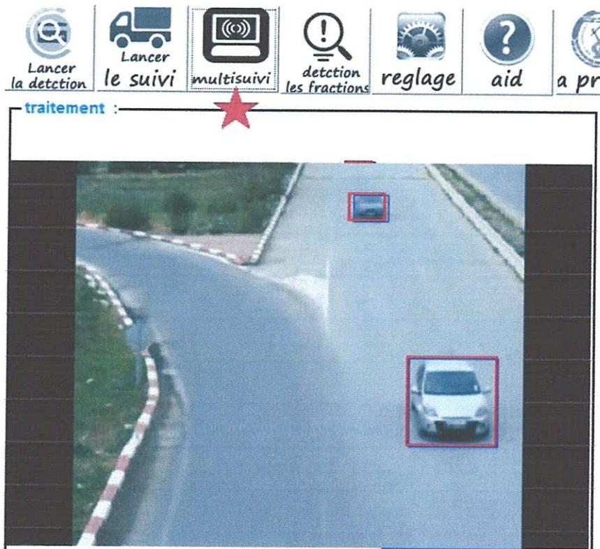
Figure IV.15: Suivi Multi-véhicules, le rectangle rouge estimé, le rectangle bleu mesuré.
