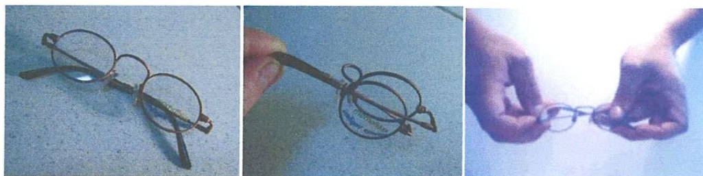
Figure I.11. Les lunettes "intelligentes" font appel aux alliages super-élastiques.
