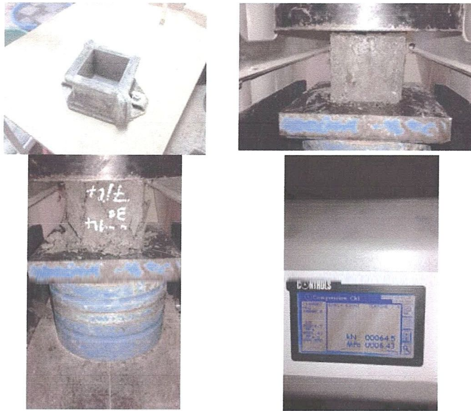
Figure II. 6 l'essai de compression a l'état durci
