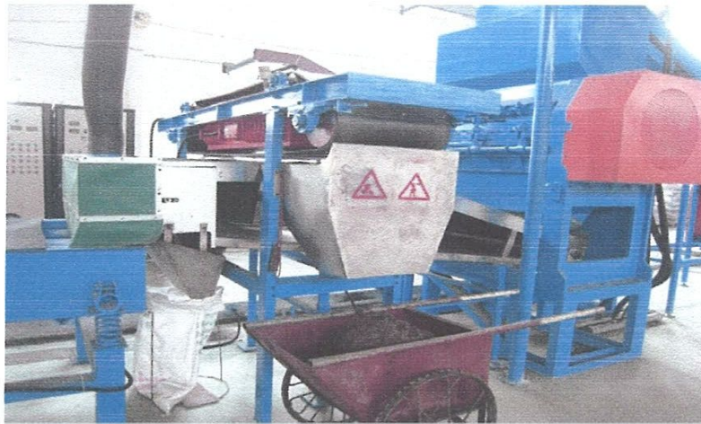
Figure II. 2 : machine pour la production de poudrette de caoutchouc
