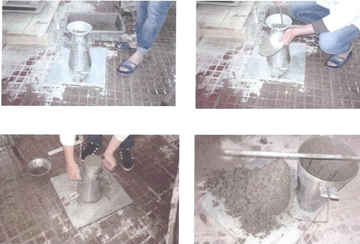
Figure II. 4 l'essai de mesure de consistance du béton frais
