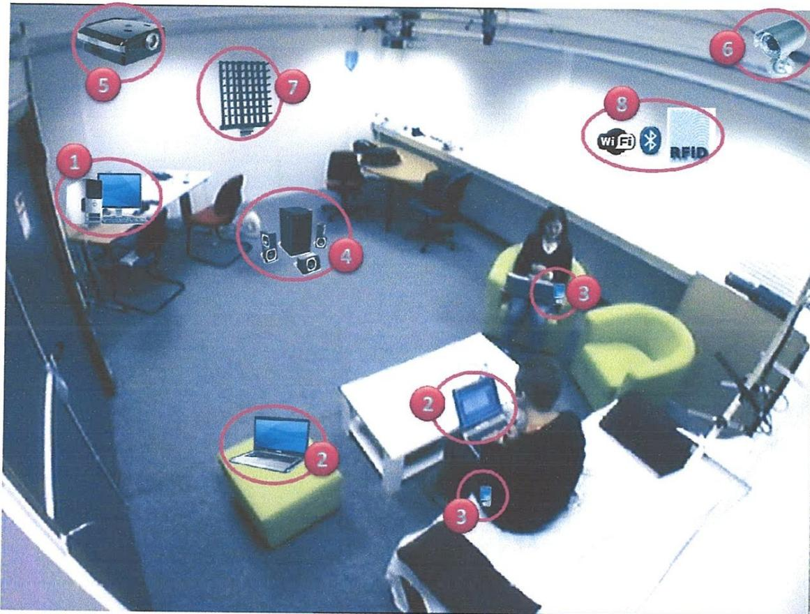
**Figure 1.2:** Un exemple de «bureau ubiquitaire» (le SmartOffice de l'équipe PRIMA) : un monde où l'utilisateur est entouré de divers appareils avec lesquels il interagit et qui communiquent également entre eux.
