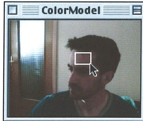
Figure 1.13 : Constitution du modèle de couleur par l'exemple. Un cadre, défini à la souris, délimite l'ensemble des pixels qui serviront d'exemple pour la constitution du modèle
