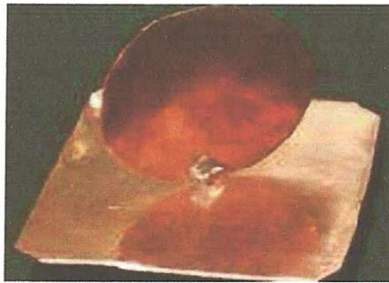
**Figure III.10:** antenne monopole circulaire
