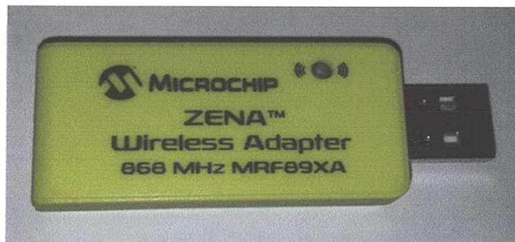
Figure I.13 : Adaptateur sans fil de ZENA.
