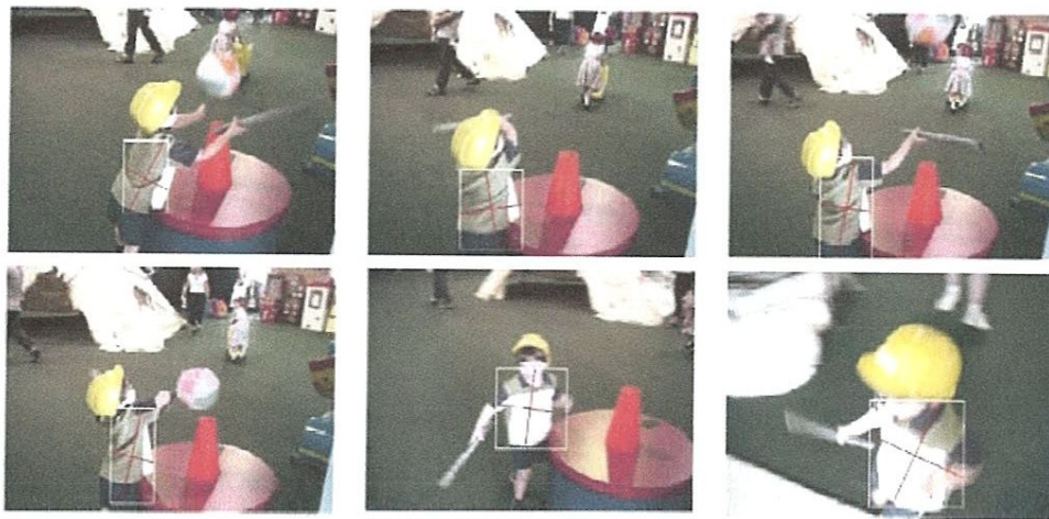
Figure III.10 : Exemple de suivi d'objet à l'aide de l'algorithme CamShift
