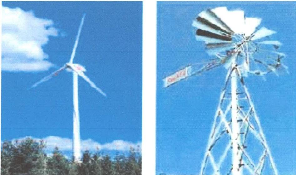
Figure I.4 : éoliennes à axe horizontal
