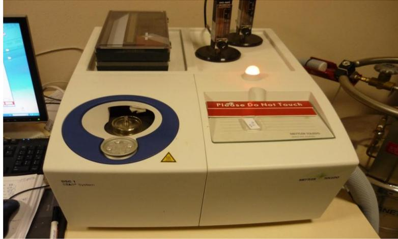
**Figure 2.2** Calorimétrie différentielle à balayage DSC
