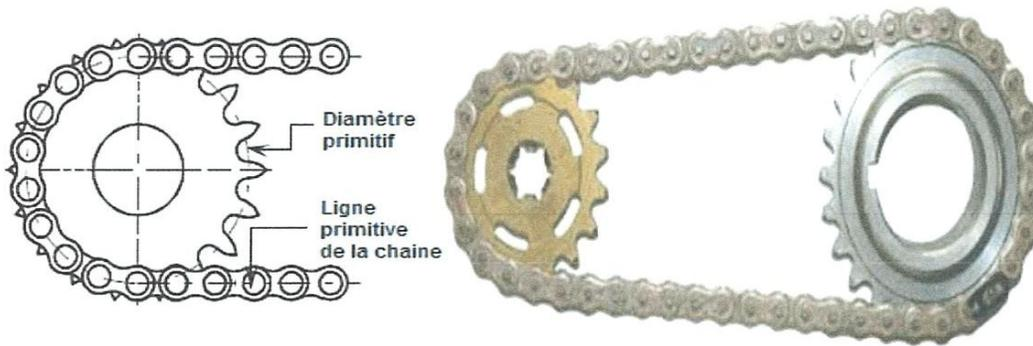
Figure 1.12. Transmission par chaîne
