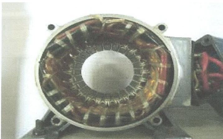
Figure 1.1. Photo du stator d'une machine asynchrone
