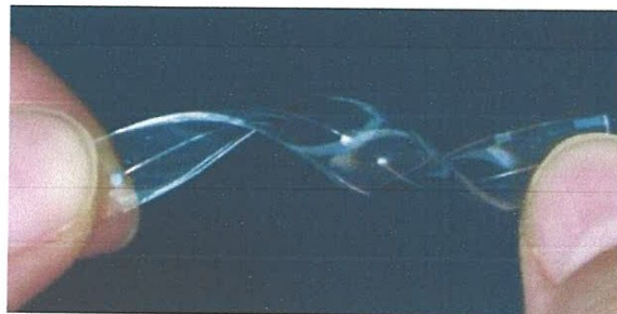
Figure I-16 : antenne miniature sur une substrat souple
