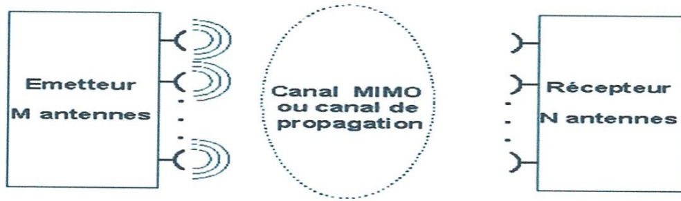
Figure II-20 : Principe du MIMO
