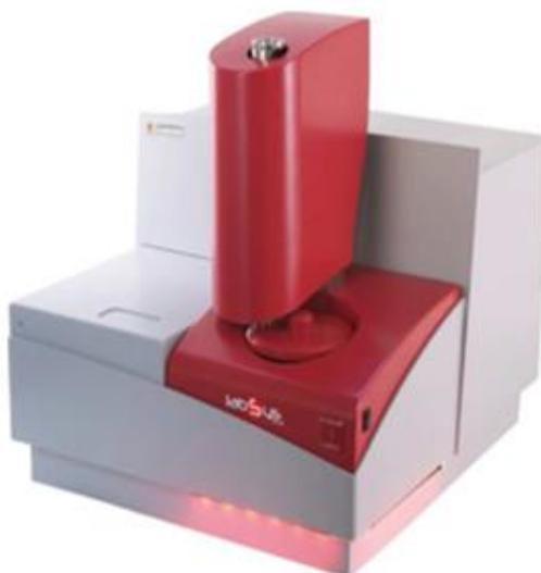
**Figure 2.9** : L'appareil d'analyse calorimétrique différentielle à balayage utilisé (DSC *SETARAM LABSYS evo*).
