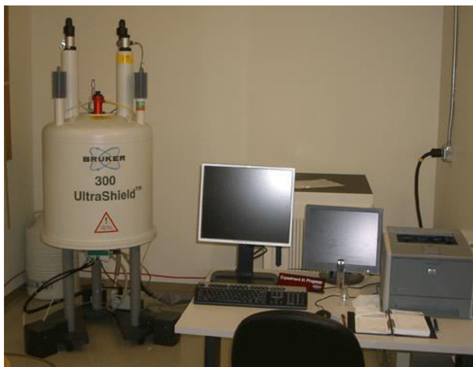
Figure II.18 : Dispositif d'analyse RMN ^{13}\text{C} . Laboratoire IMP,Lyon.
