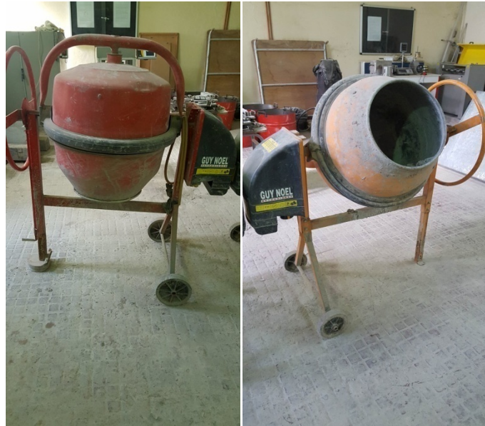
Figure III.2. Malaxeurs électriques du béton
