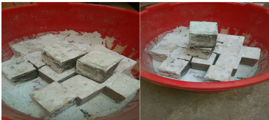
Figure III.6. Eprouvettes après conservation dans la solution de sulfate de sodium ( \text{Na}_2\text{SO}_4 )
