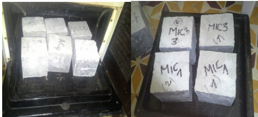
Figure III.9. Le dispositif de chauffage des éprouvettes dans un four électrique
