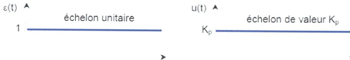
Figure I.10 : Entrée et sortie du correcteur P.
