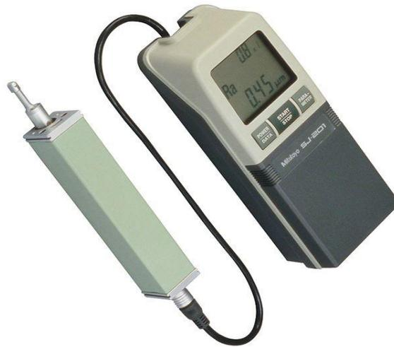
**Figure II.8.** Rugosimètre 2D.
