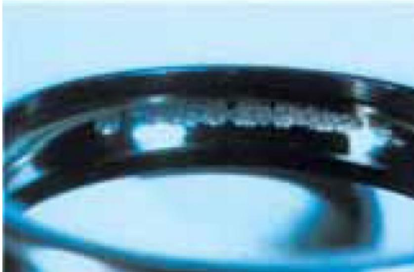
**Figure I.3** – Ecaillage d'une piste de roulement
