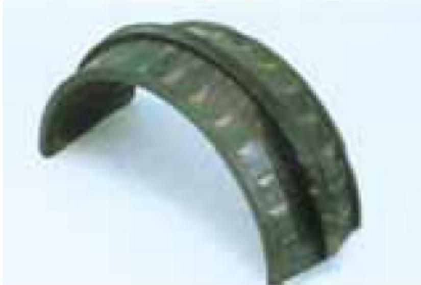
**Figure I.9** – Blocage de roulement
