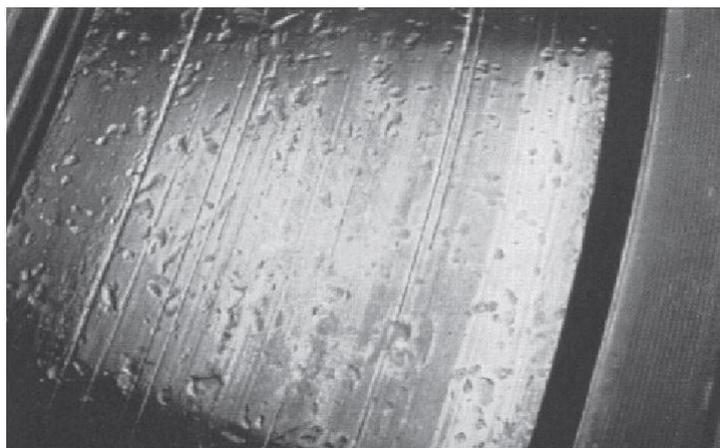
**Figure I.7** – Marques d'indentation d'un chemin de roulement dues à la présence de contaminant
