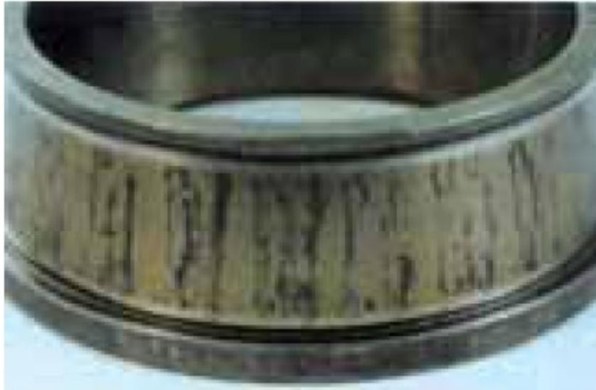
**Figure I.6** – Criques de corrosion sur une piste de roulement
