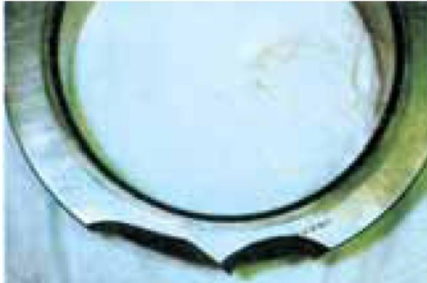
**Figure I.5** – Cassure d'une bague
