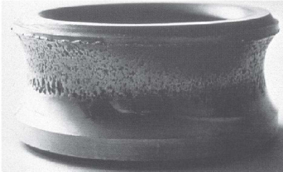
**Figure I.2** – Aspect de la bague interne d'un roulement surchargé
