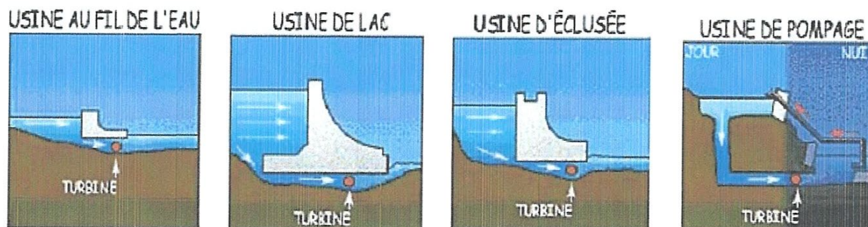
Fig I.9: Schéma présente les types de centrale hydraulique
