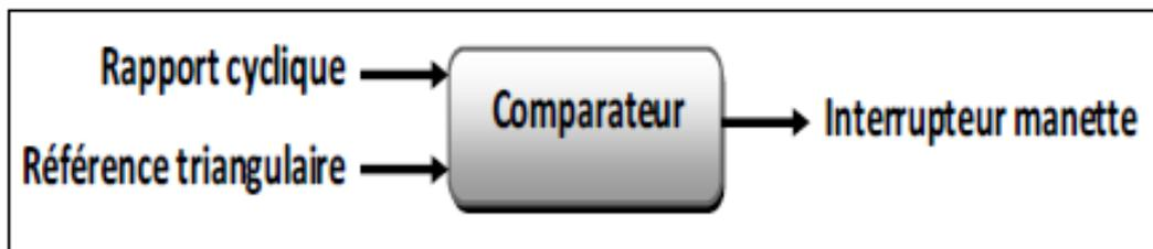
FIG. 3.7 – Schéma synoptique d’un circuit MLI.
