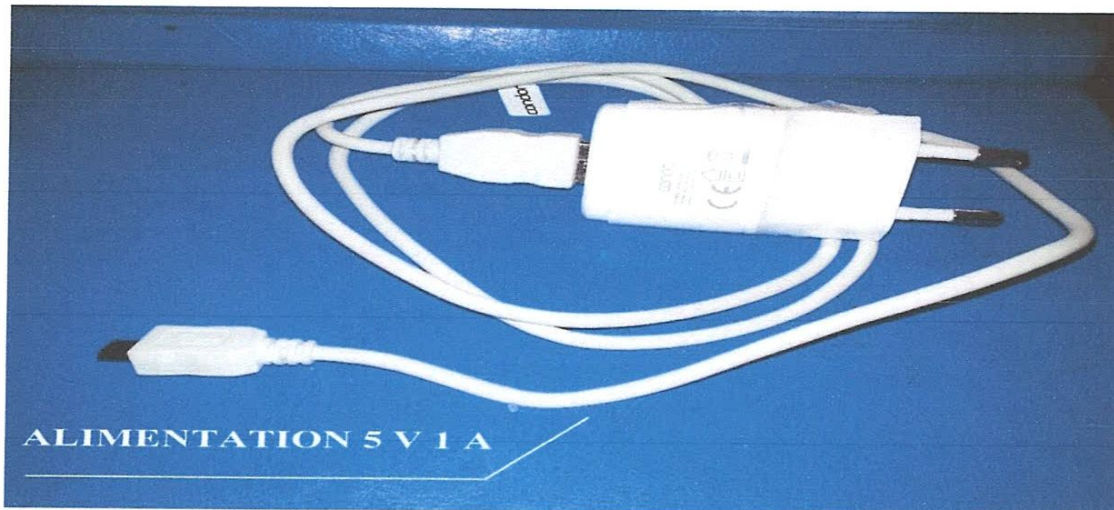
Figure 3.3 : Alimentation pour raspberry pi 5 V et 2.5A
