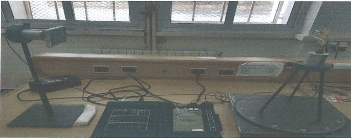
Figure III.18 Les appareils de mesure de diagramme de rayonnement
