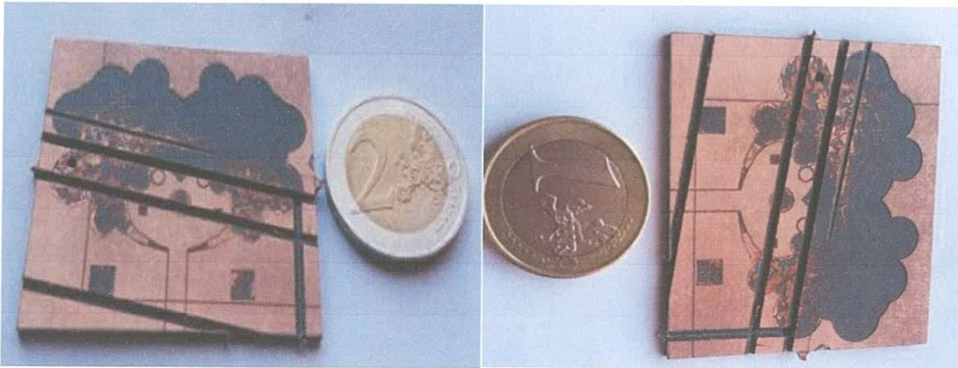
Figure III.13 L'antenne UWB à fente réalisée sur le Duroid
