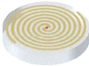
Figure II.6 : Antenne spirale d'Archimède sur cavité
