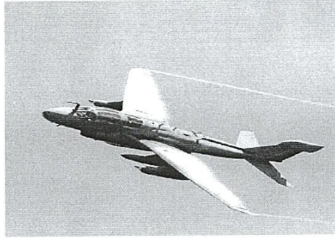
Fig.2.3. Exemple de condensation sur l'aile et de « trainée » se condensant en bout d'aile
