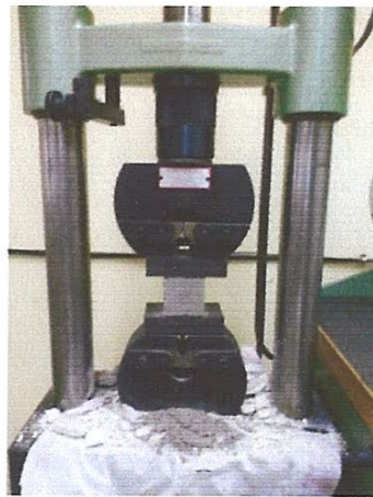
Figure 15 : Photo de l'appareil utilisé pour les essais de compression
