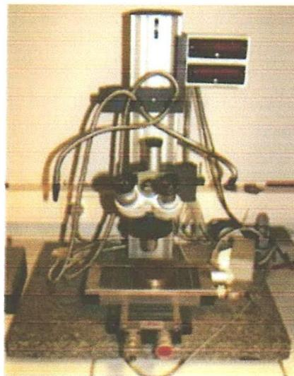
Figure 15 : Microscope chauffant de type « Leitz »
