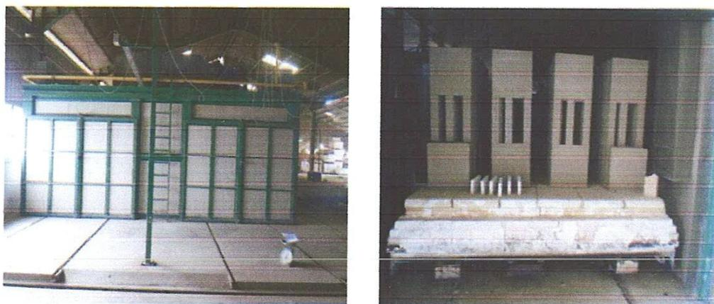
Figure 19: photos du séchage des échantillons
