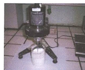
Figure(5): Contrôle des produits en cours de fabrication (finesse, viscosité)
