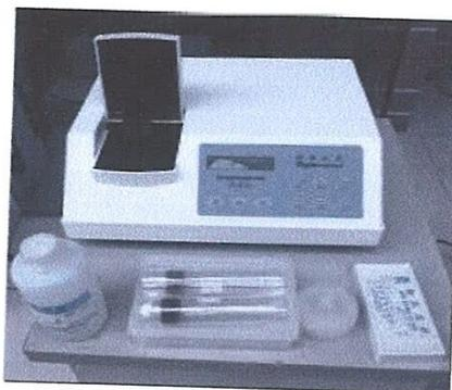
**Figure 18 Turbidimètre**
