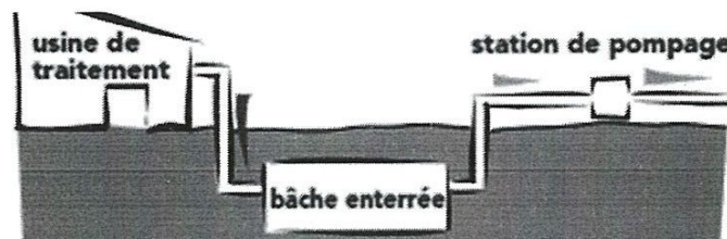
Fig.II.7 La station de pompage refoule l'eau traité vers les réservoirs relais.
