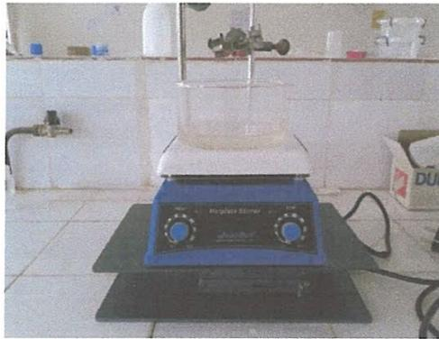
**Figure : Plaque chauffante avec agitation LABTECH**
