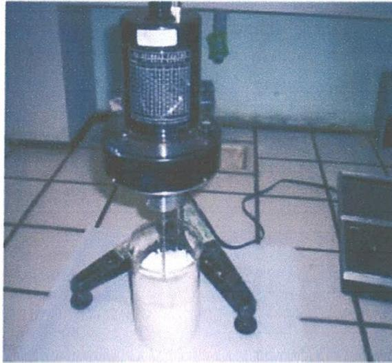
*Figure IV.2: Viscosimètre « Brookfield »*
