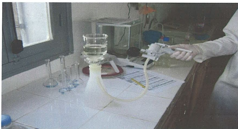
Figure.3.12. Filtre à pompe.
