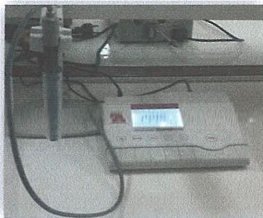
Fig. III.2 : Conductimètre Ohaus 3100
