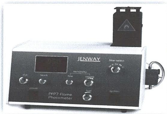
Fig. III.7 : Photomètre à flamme de marque PFP7 [27]
