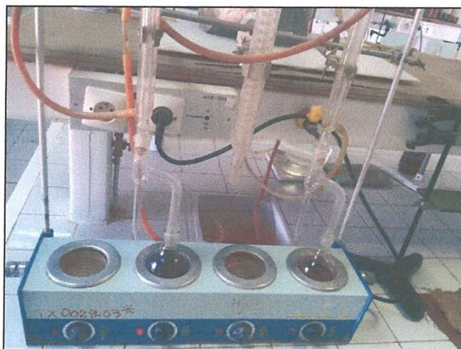
Figure III-12 : montage de l'appareil pour la mesure du teneur en eau.
