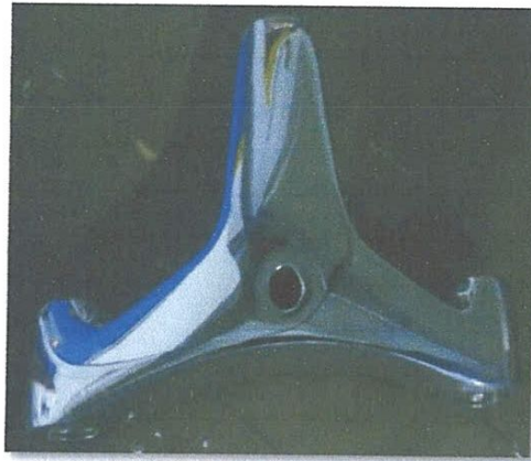
Figure 17 : Aspect d'un robinet après chromage.
