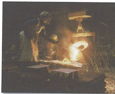
Figure 05 : Photot du coulage par gravité.
