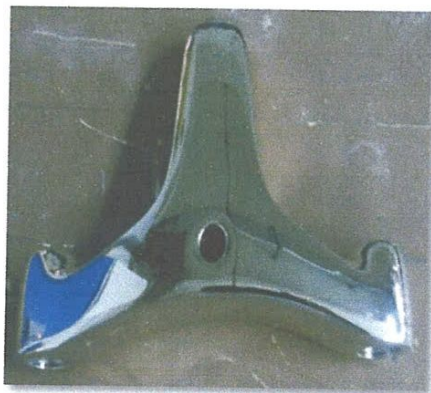
Figure 15 : Aspect d'un robinet après nickelage.
