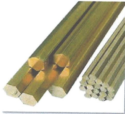
Figure 09 : Aspect des barres achetées pour le décolletage.
