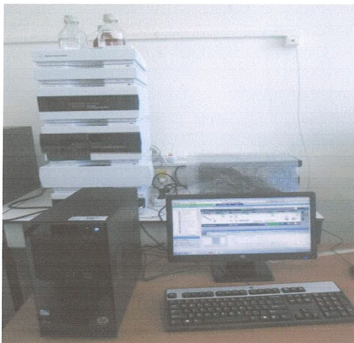
Figure III.2 : HPLC (Agilent 1260) utilisé pour le dosage des principes actifs de (Laboratoire de Chimie Appliquée, Université de Guelma).
