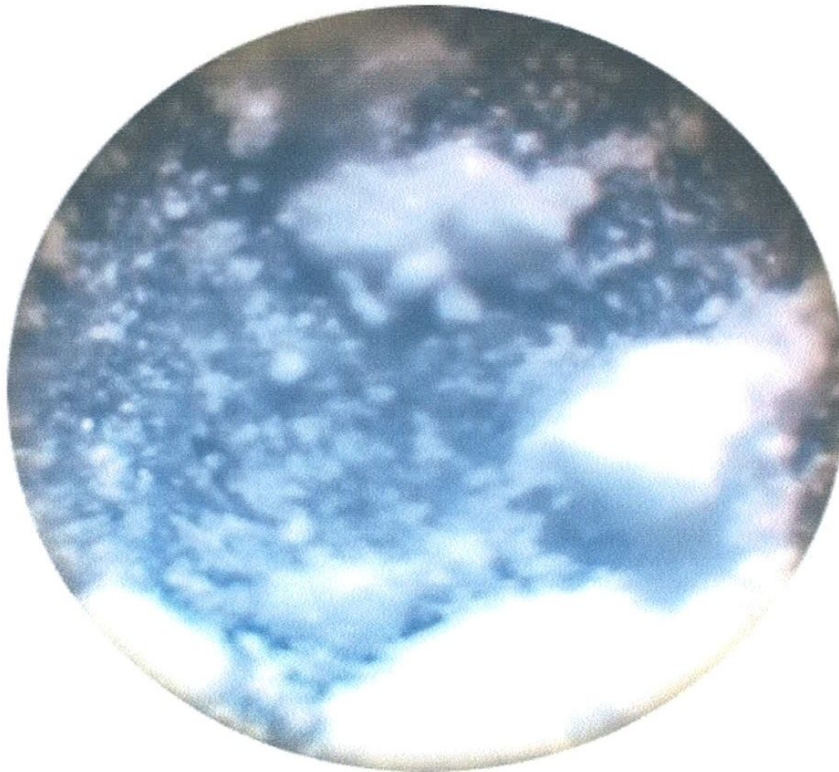
Figure 4-10 : Image par microscope optique de l'électrode de carbone (a) C2 grossissement 300, (b) C2-ZnO grossissement 300.
