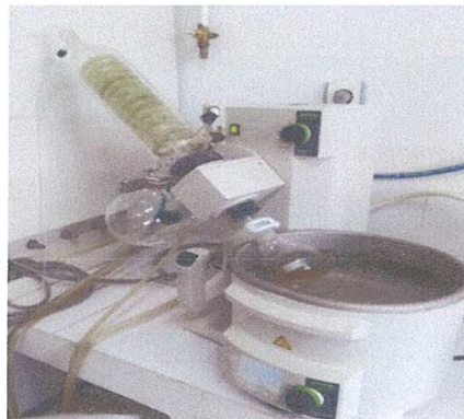
Figure III.4 : Le montage de la distillation sous vide avec le rotavap.
