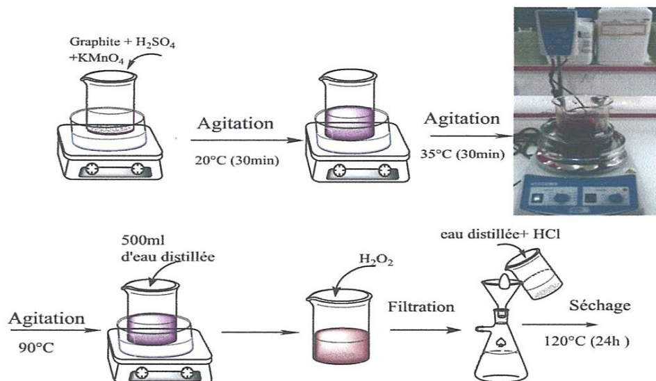
Figure III.5 : Etapes de production de l'OG par la méthode d'Hummers
