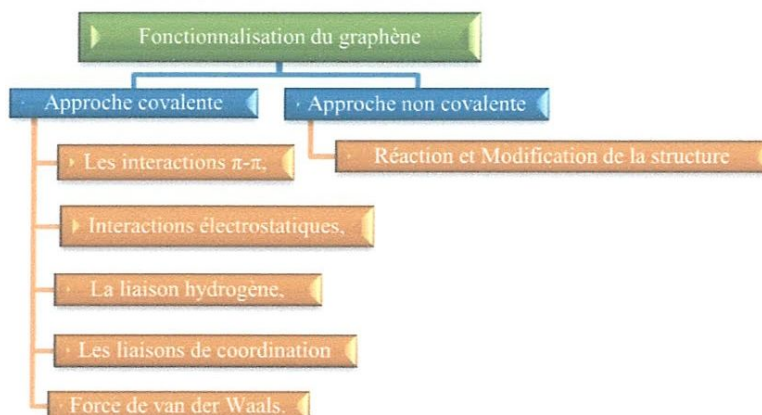
Figure I.23 : la fonctionnalisation covalente et non covalente du graphène.
