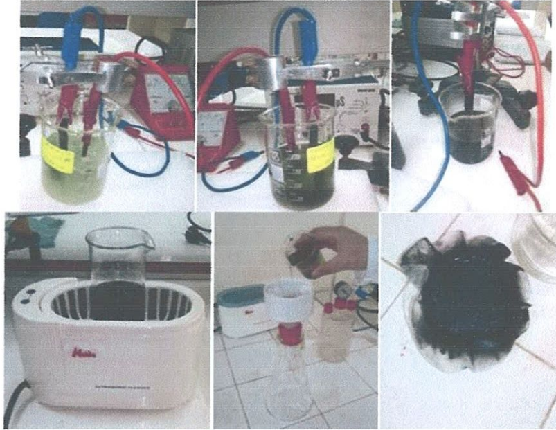
Figure III.2 : Etapes de production de l'OGr par exfoliation électrochimique De graphite dans \text{FeSO}_4
