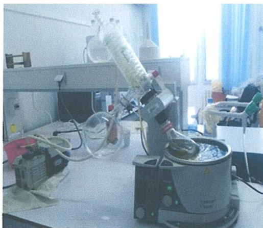
Figure 3 : Evaporateur rotatif ; Heidolph-Laborota 4000 (Laboratoire de Chimie Appliquée, Université de Guelma).
