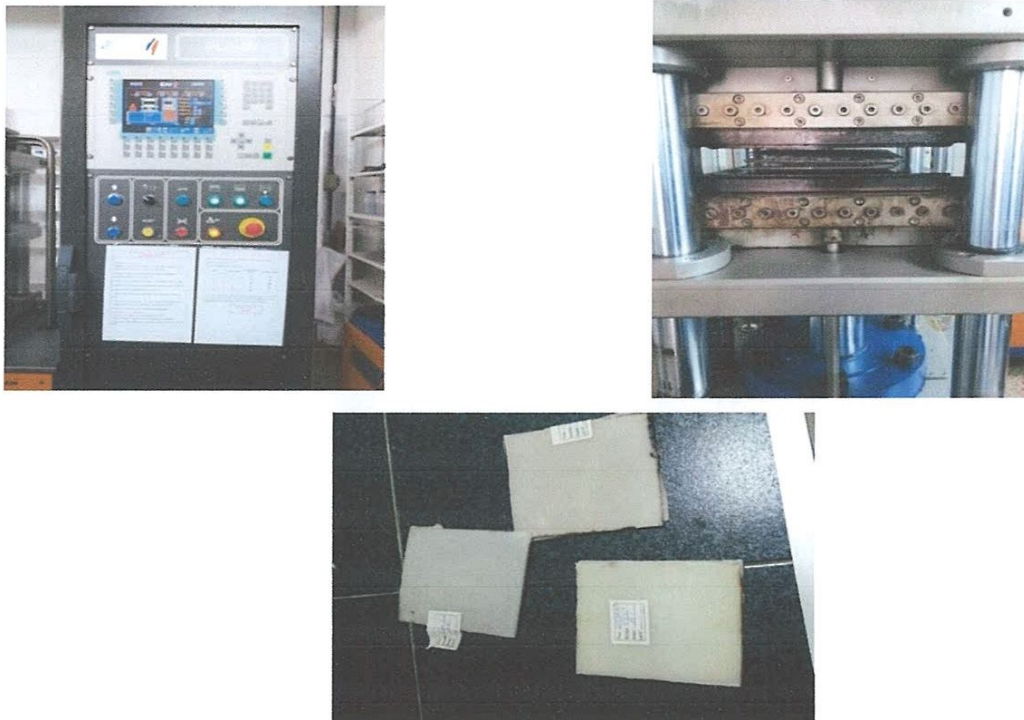
Figure III.4 : L'opération de thermocompression par la presse hydraulique.
