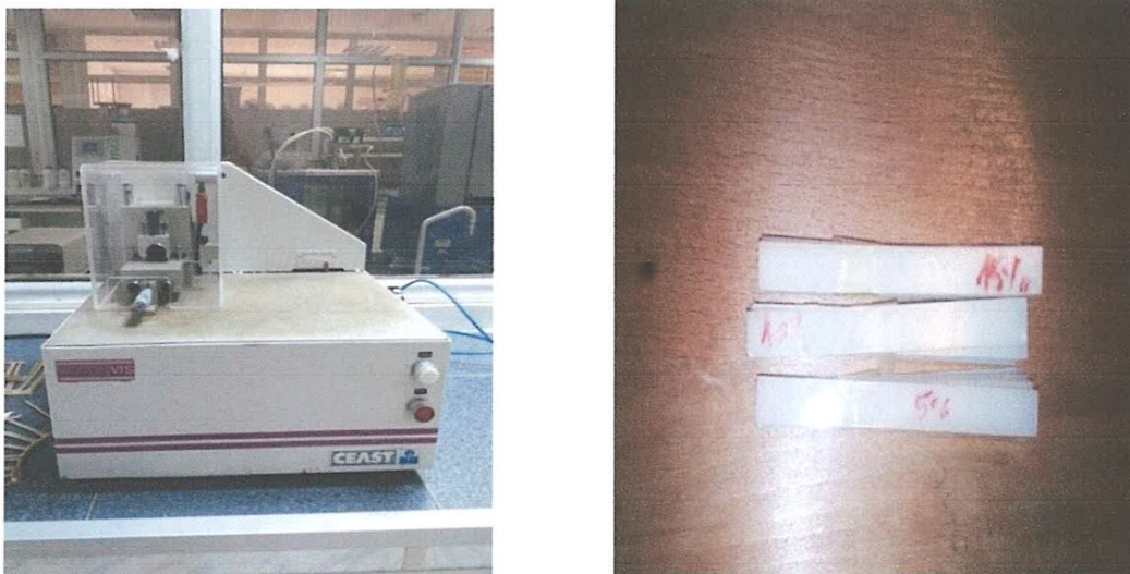
Figure III.6 : Entailleuse pour entailler les échantillons de la résilience IZOD
