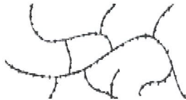
Figure. I.3 : Représentation schématique d'un polymère Tridimensionnel [3].
