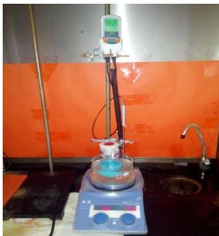
**Fig.III.5:** Montage de la réaction de complexation selon la méthode de Co-précipitation.
