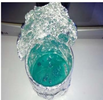
**Fig.III.6:** Montage de la réaction de complexation selon la méthode de Cristallisation.
