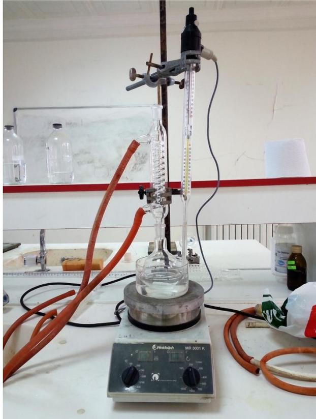
Figure IV-6 : Montage d'indice de saponification
