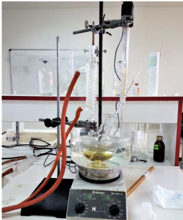
**Figure III-1 : Montage de transestérification**
