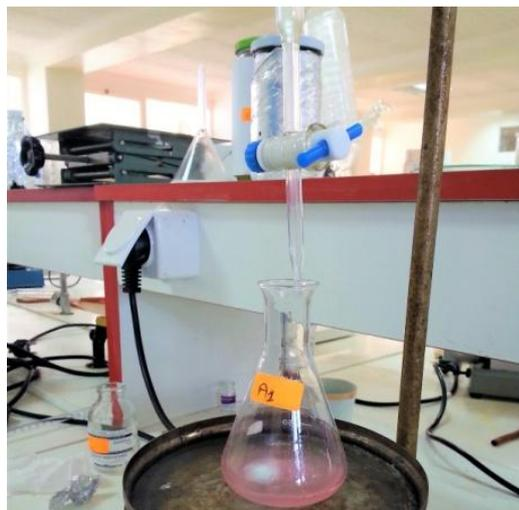
**Figure IV-3 : Résultat de titrage d'indice d'acide**
