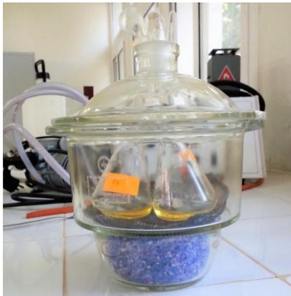
**Figure IV-1 : Montage suivie pour la détermination d'humidité et impureté**
