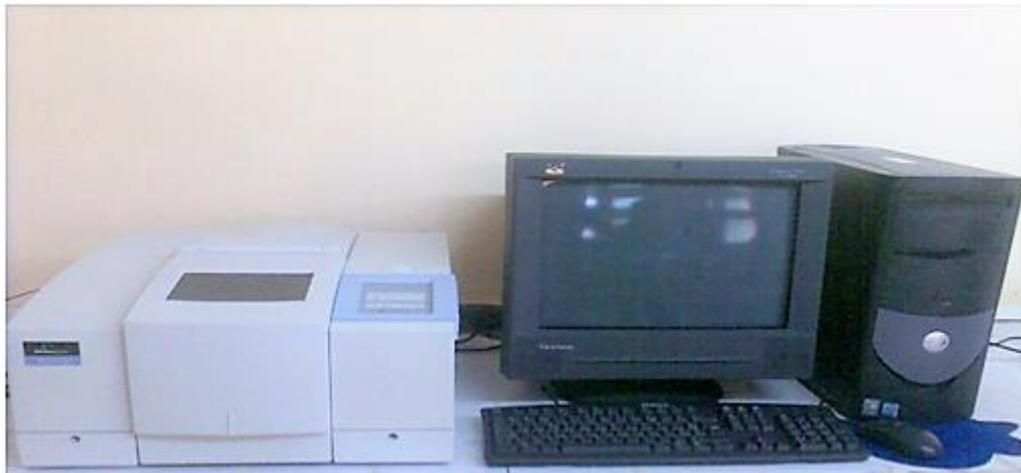
**Figure III-7 : Spectromètre FTIR « Spectrum One »**
