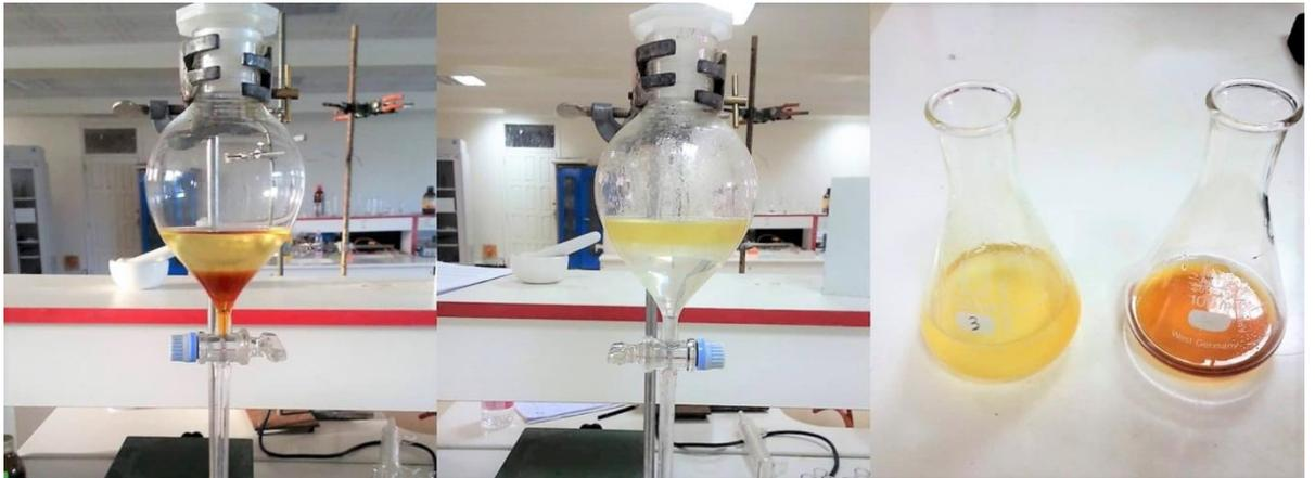
**Figure IV-8 : Décantation, lavage et séparation du biodiesel**
