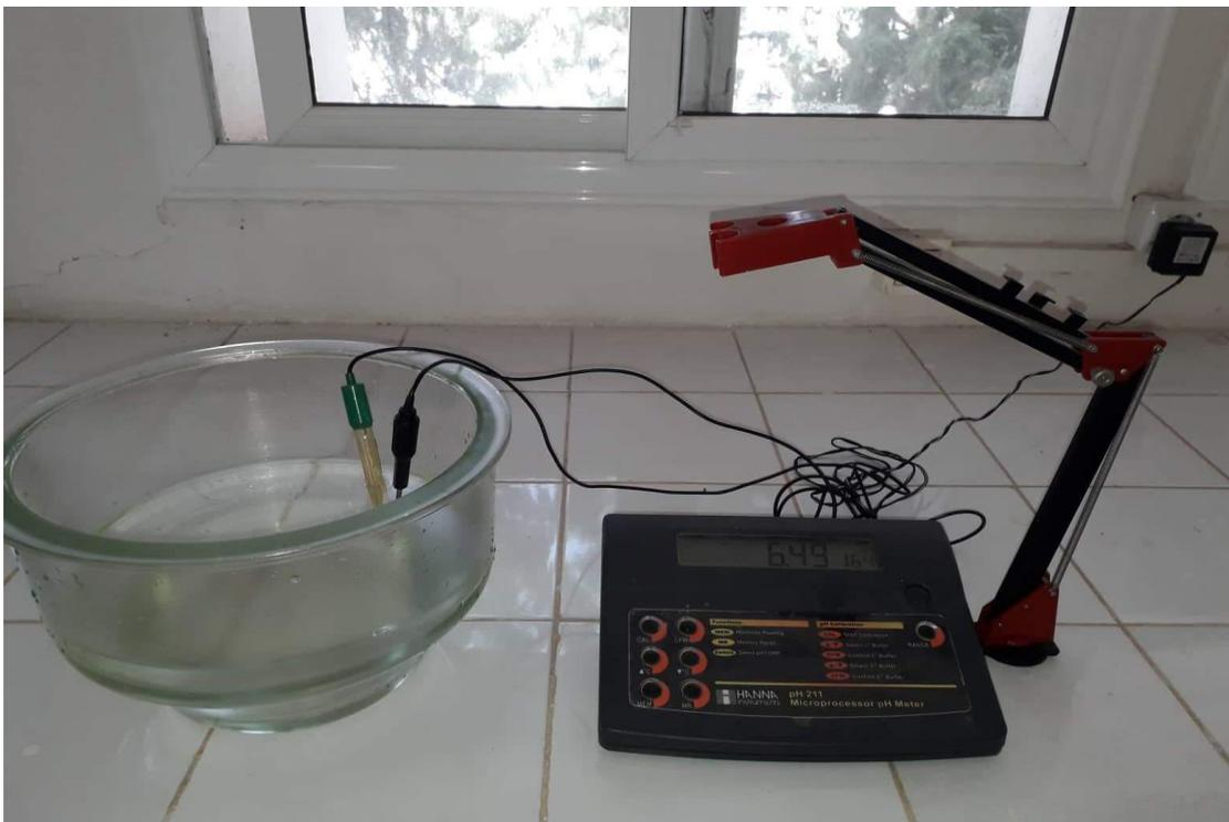
Fig.V.16. Acidification des échantillons
