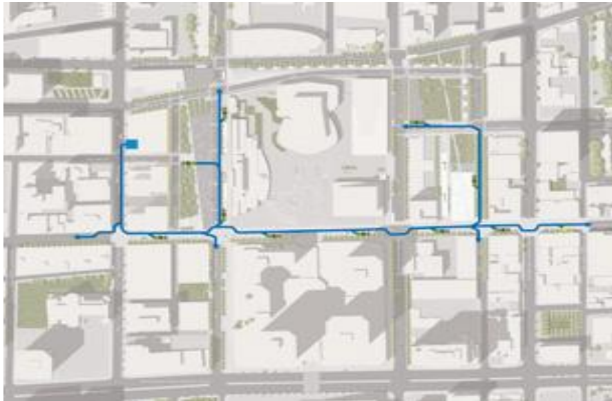
Figure 31 : Quartier des spectacles : système de collecte pneumatique des déchets
