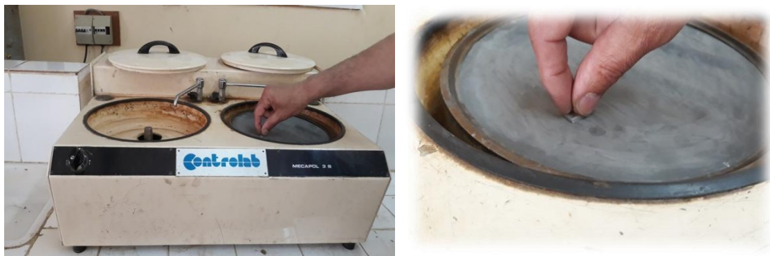
Figure III. 2. Polisseuse mécanique de type MECAPOL 3B utilisée.
