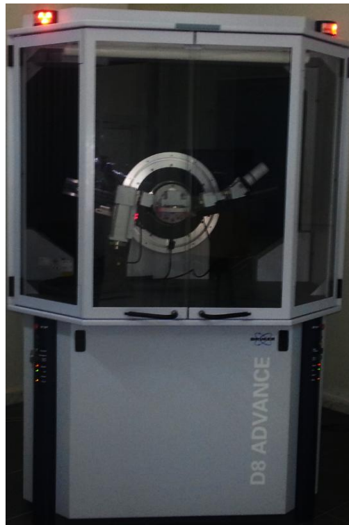
Figure III. 9. Diffractomètre utilisé de type Bruker D8 Advance.
