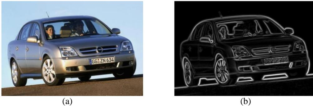
**Figure I.7:** exemple de détection de contour a partir d'une image
