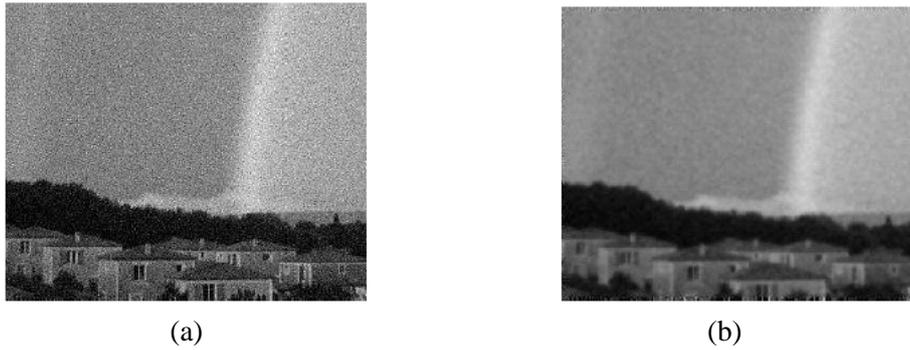
**Figure I.8:** exemple d'application d'un filtre moyenneur [LIN04]
