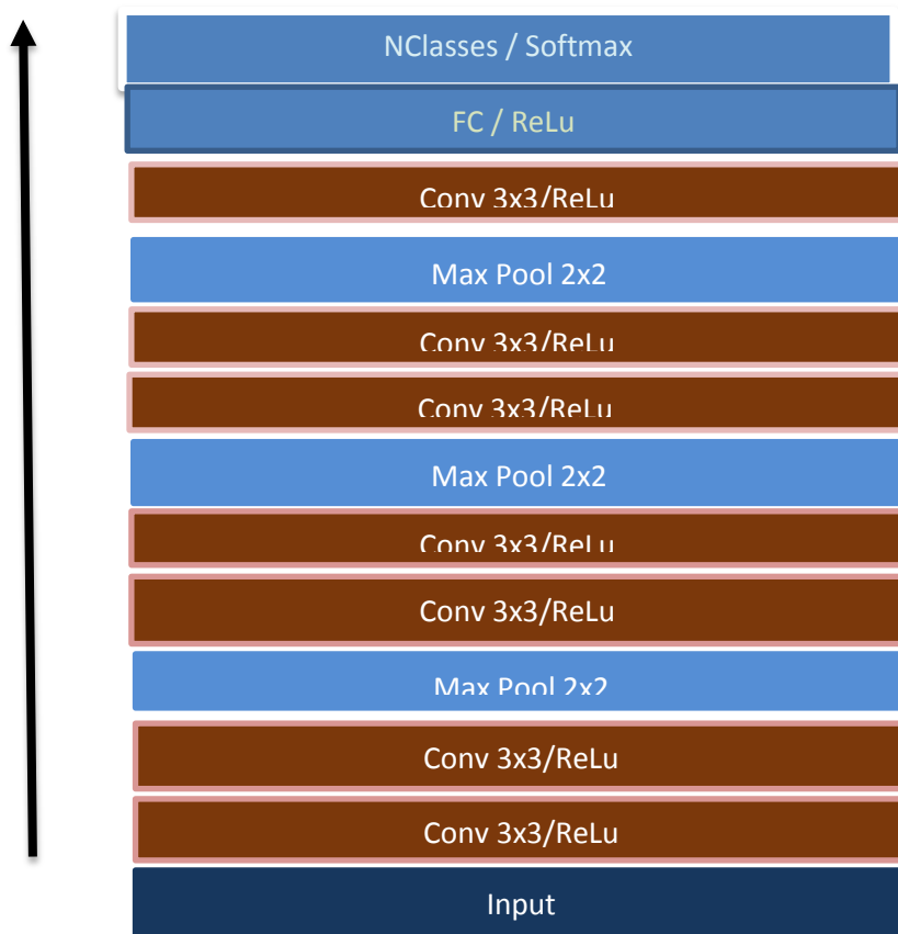
Figure 7. Architecture générale d'un CNN.
