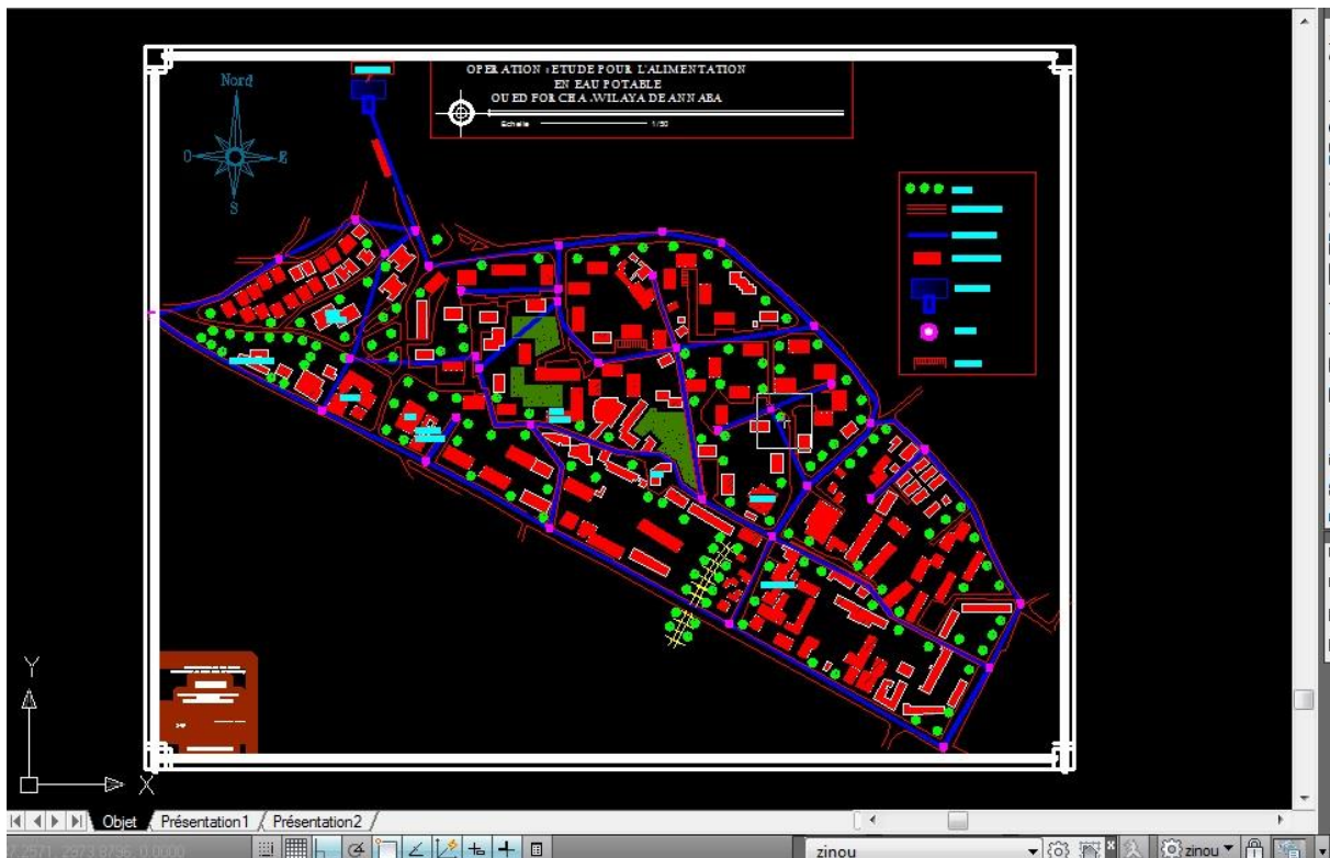
Figure 4.3 : schéma d'implantation du réseau AEP de la zone d'étude par l'Auto CAD
